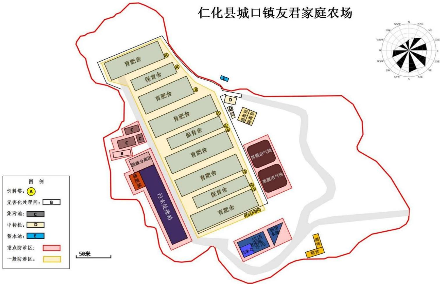
图6.2.3-1 项目地下水分区防渗示意图
