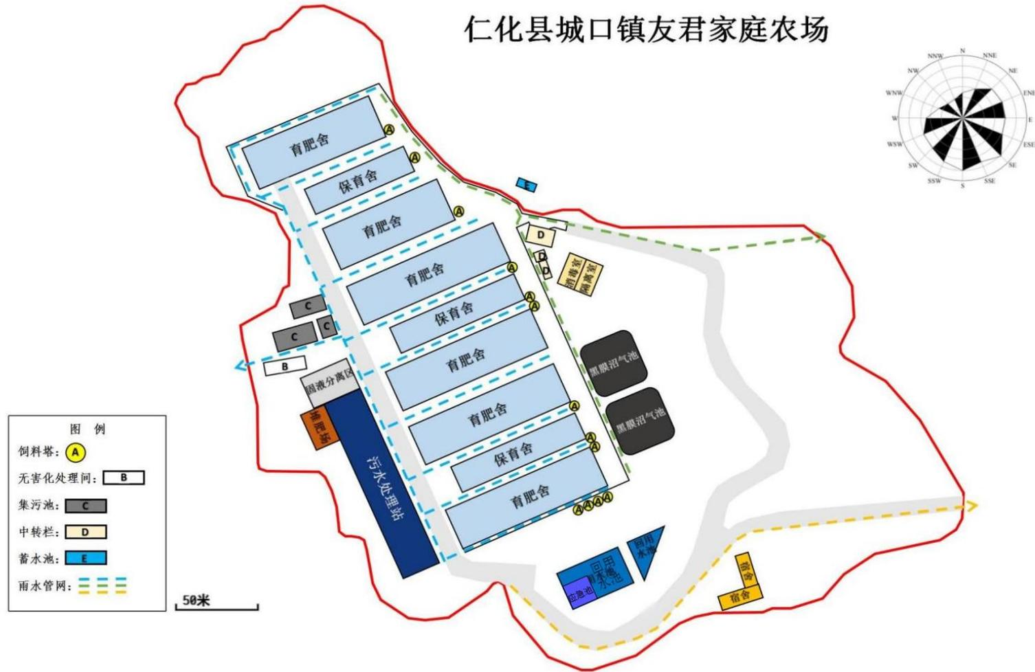
图3.2.2-4 雨水管网布置图
