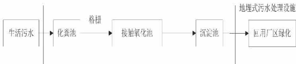
图 6.1-3 项目生活污水处理工艺流程图
