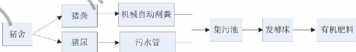
图 3.3-2 粪污处理工艺流程图
